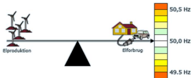
Figur 8: Illustrasjon av balansering mellom produksjon og forbruk for å sikre riktig frekvens
